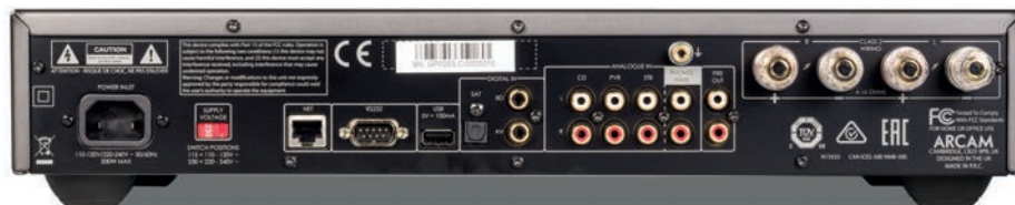
Zadní panel HDA SA20 upoutá mj. ethernetovým vstupem LAN, který slouží nezvykle pouze k ovládní komponentu prostřednictvím lokální sítě.
